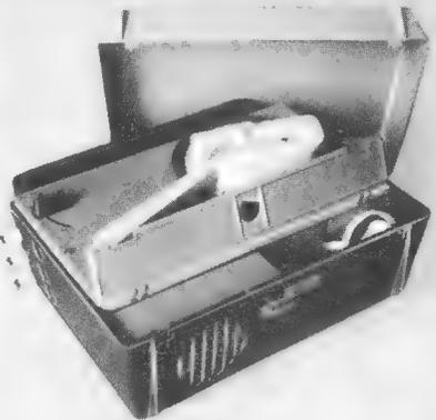
Bild 11. Unterteil des Phonokoffers mit Schallöffnung
