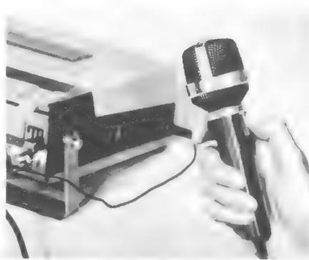
Bild 6. Dynamisches Reportermikrofon M 512 (Uher)
