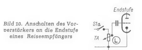
Bild 10. Anschließen des Vorverstärkers an die Endstufe eines Reiseempfängers
