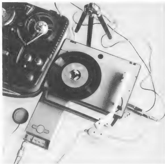
den Verstärker abschaltet. Die 6,4-V-Speisespannung wird über ein verdrehtes Litzenpaar zur Verstärkerplatte geführt.
